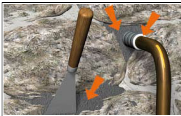
Situation après travaux de colmatage
