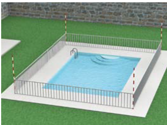
Piscine privée équipée d'une barrière de sécurité
